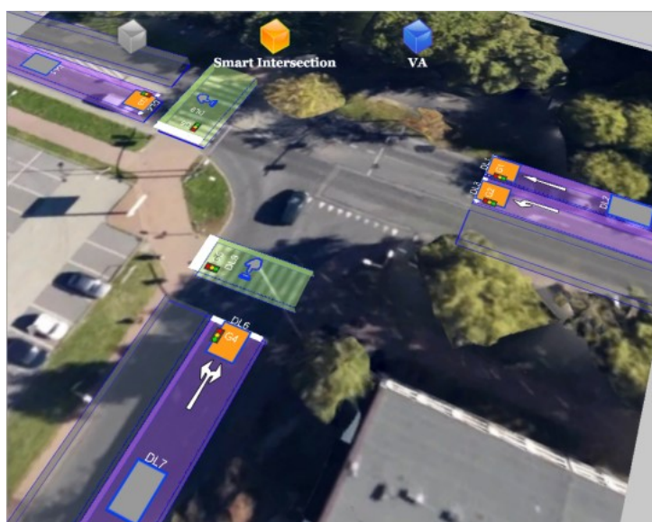
Figura 33 – Posicionamento dos detectores no SMART INTERSECTION
