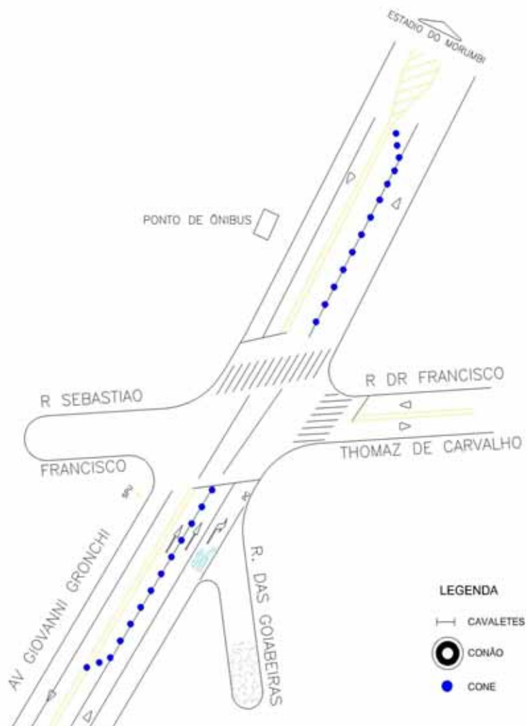
Figura 13 – Faixa adicional reversível para a entrada: Av. Giovanni Gronchi junto ao cruzamento da R. Francisco Tomas de Carvalho.
